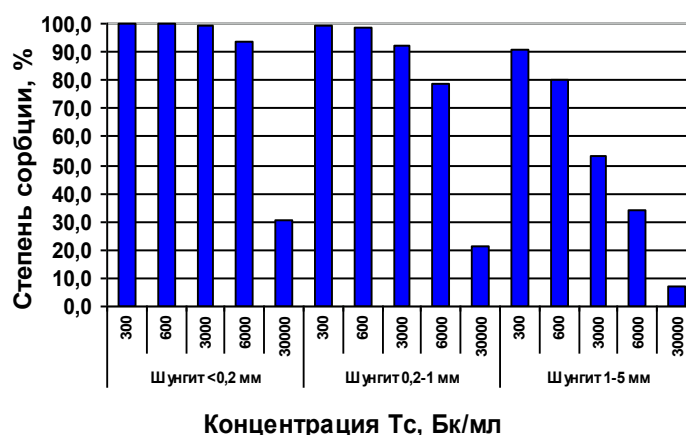
Рис. 1. Сорбция пертехнетат-иона на максовите различного фракционного состава.
