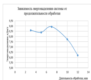
Рис. 2. График зависимости энерговыделения системы от продолжительности обработки
